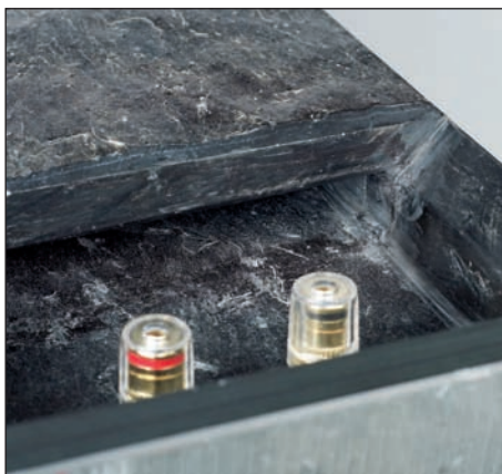
Gut versteckt: der Reflexkanal mündet auf der Rückseite der Box über den Anschlussklemmen
